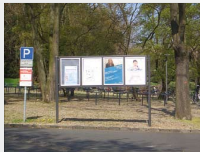
Infoboard mit vier einseitig aufgesetzten Klapprahmen (DIN A1) auf freistehendem Standgestell
