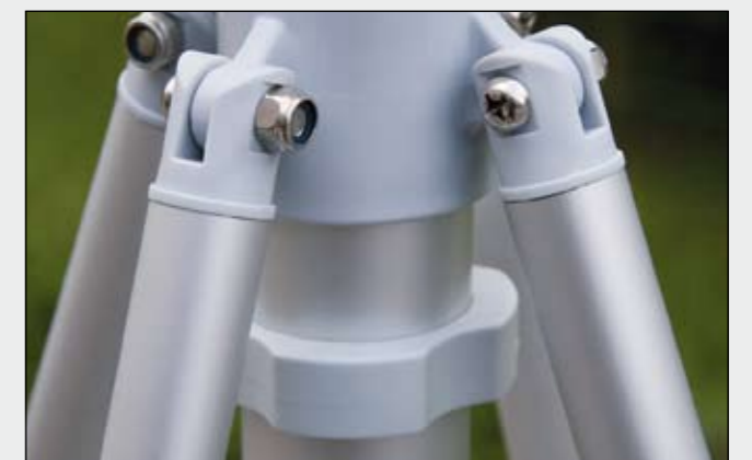
Ausklappbare Standfüße mit Verbindung zum Kunststofffuß
